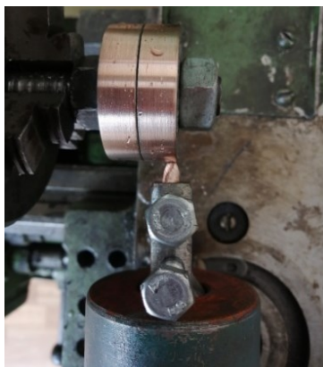
Рисунок 2 – Нанесение пленочного покрытия методом ФАБО
